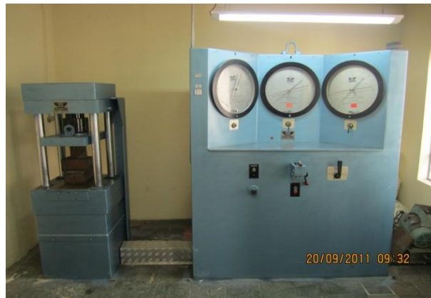
Fig. 1. Equipo de cagar a compresión paralela Servintegral.
