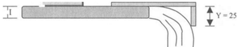
Figura 3. Medición de caudal en una tubería llena horizontal, utilizando el método de la trayectoria. Fuente: Bello et al, 2000.
