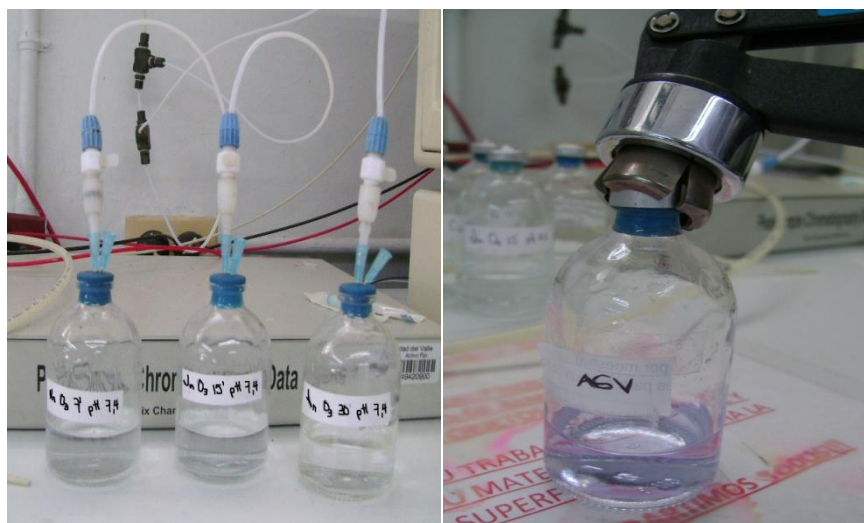
Figura 15. a) desplazamiento de O_2 con nitrógeno. b) cierre de los reactores con sello metálico.
