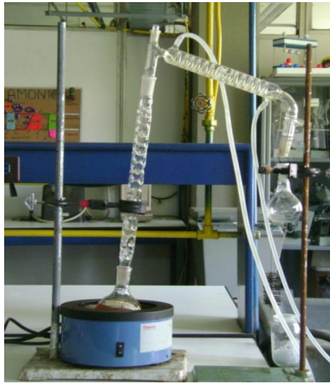
Figura 13. Montaje de destilación extractiva
