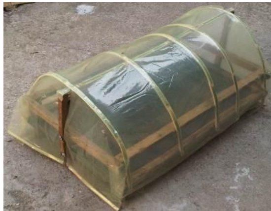
Figura 13. Secador solar parabólico en guadua-madera
