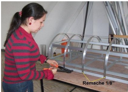
Figura 9. Construcción de secador solar parabólico.
