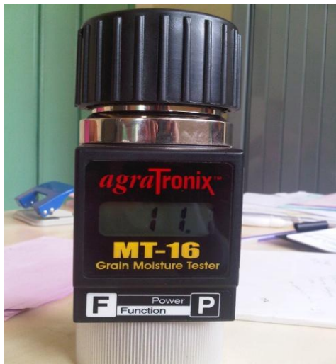
Figura 28. Determinador de humedad de marca MT-16™
