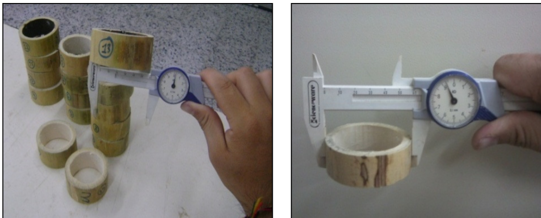
Figura 9. Medición del diámetro interno y externo con el calibrador
