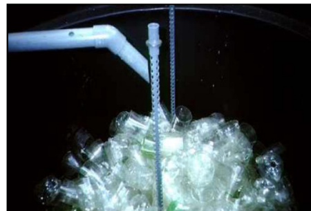
Figura 4. Botellas plásticas como medio de soporte para aguas residuales del lavado del café
