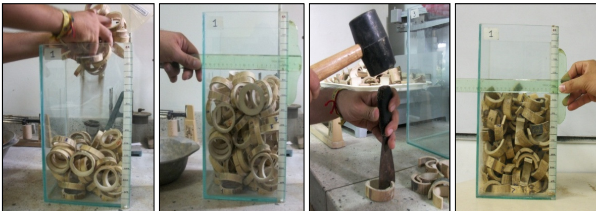
Deposito en forma Aleatoria de anillos Dentro del recipiente
