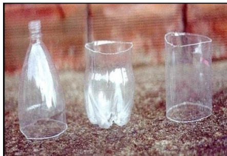
Figura 4. Botellas plásticas como medio de soporte para aguas residuales del lavado del café
