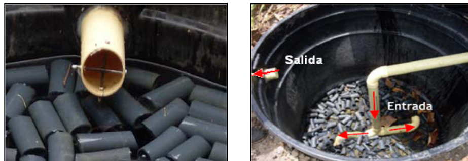
Figura 2. Trozos de manguera como medio de soporte en FAFAs para el proceso de filtración de aguas residuales industriales de trapiches paneleros
