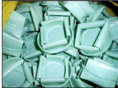
Figura 3. Vasos de polietileno como medio de soporte para el tratamiento de vinazas
