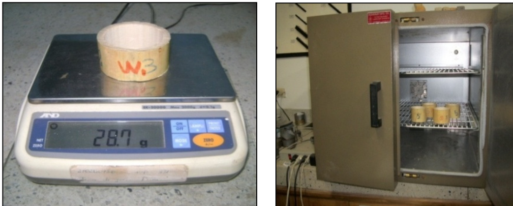
Figura 10. Pesaje de los anillos y secado en horno eléctrico Para determinación del %CH
