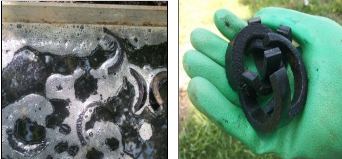
Figura 19. Capa biológica formada sobre el material filtrante
