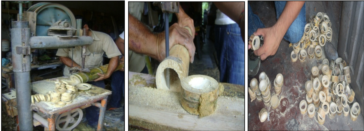
Figura 8. Corte de anillos con cinta dentada “sin fin”
