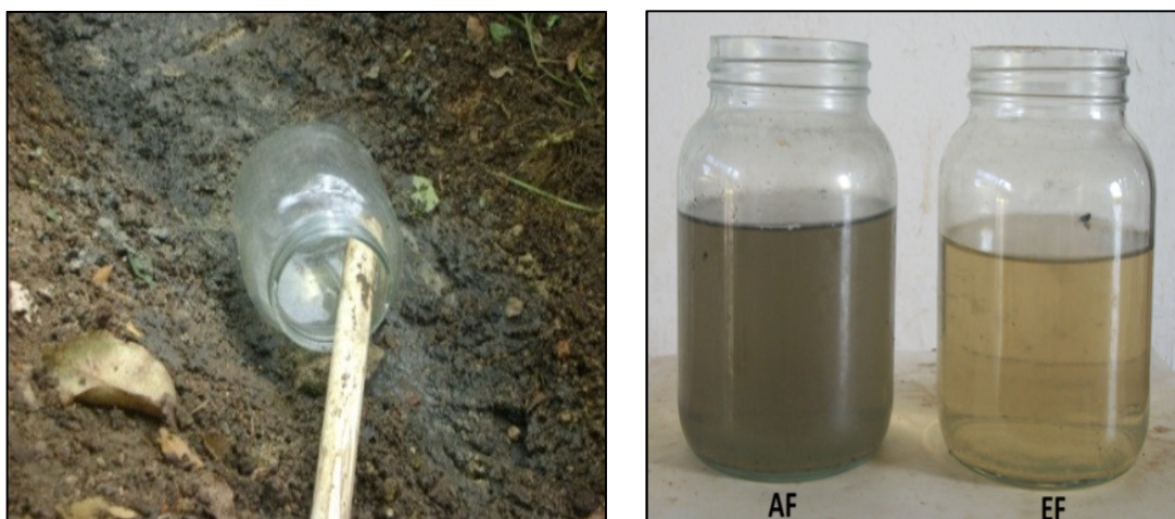
Figura 20. Muestras de AR a la entrada y salida del FAFAs
