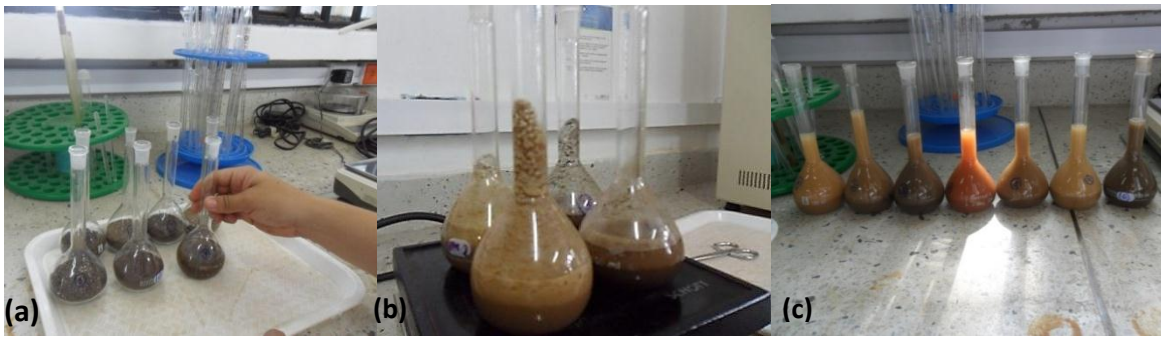
Foto 6. a) picnómetros más suelo, b) eliminación del aire en la estufa, c) volumen completado con agua.
