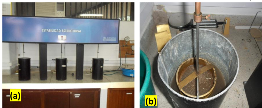
Foto 10. a) Tamizado en húmedo, b) Instalación y puesta en marcha del equipo
