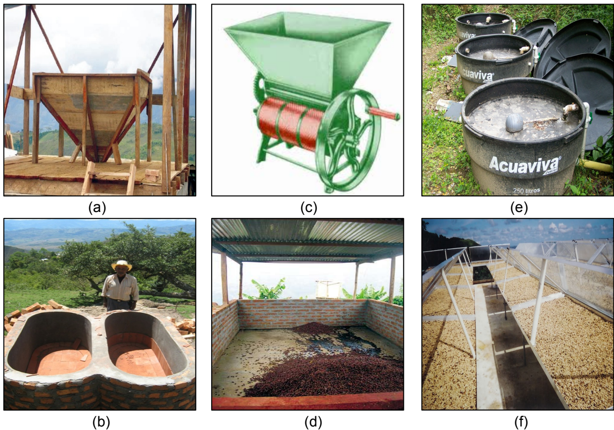
Figura 1. Elementos necesarios para el beneficio ecológico del café. (a) Tolva. (b) Tanques tina. (c) Despulpadora. (d) Fosa. (e) Sistemas Modulares de Tratamiento Anaerobio. (f) Secaderos. 8
