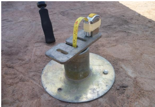
Foto No. 6 Prueba de conductividad hidráulica, Método del pozo del barrenado invertido
