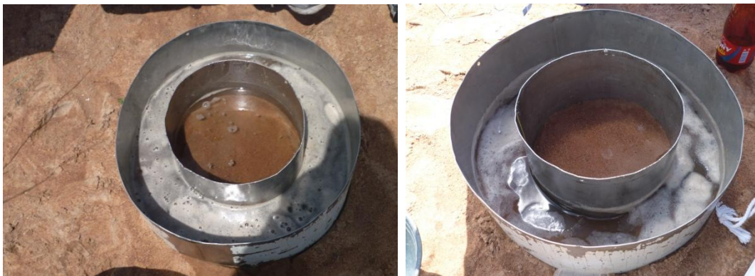
Foto No. 5 Prueba de infiltración, Método de los anillos concéntricos
