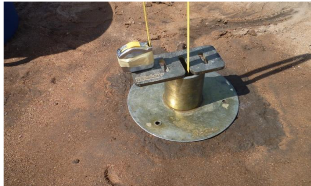
Foto No. 6 Prueba de conductividad hidráulica, Método del pozo del barrenado invertido
