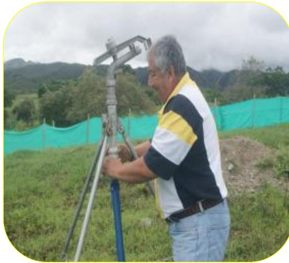
**Figura 21. Operación del Aspesor riego móvil**
