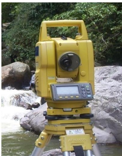
**Figura 5. Estación Total TOPCON GTS 239W**
