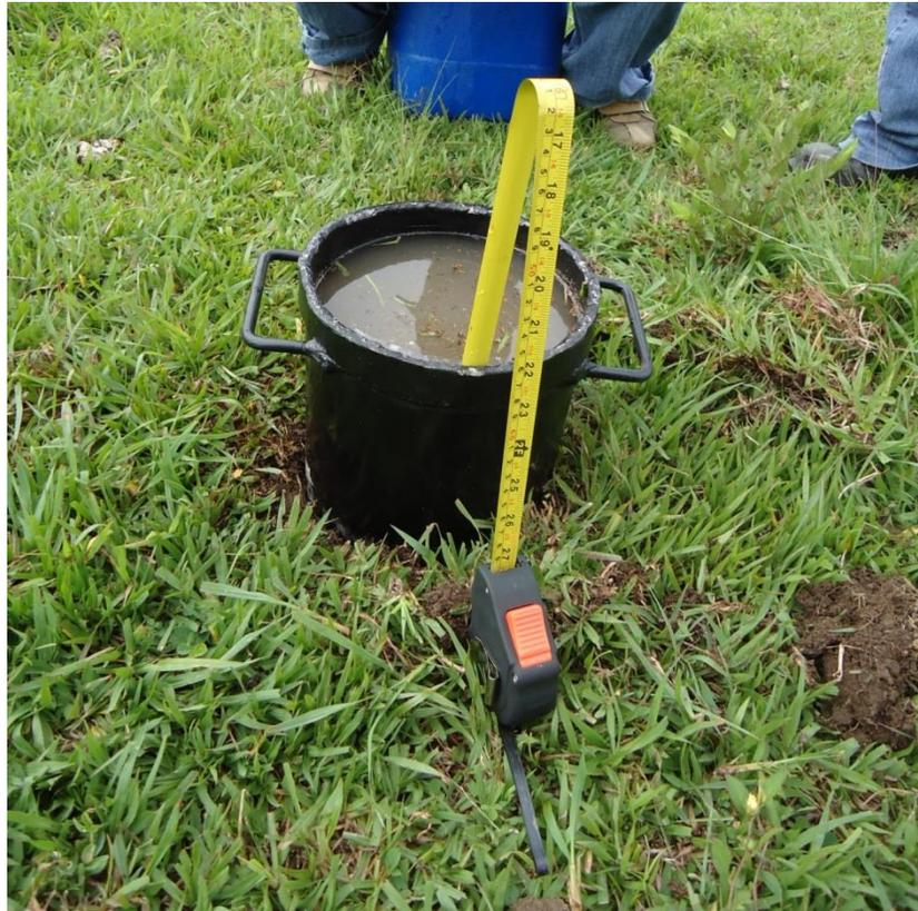
**Figura 9. Prueba de Infiltración**
