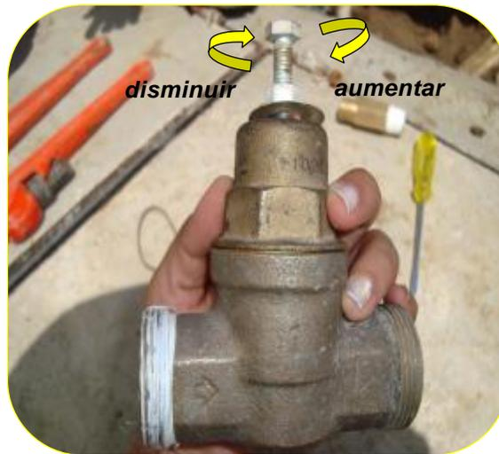
**Figura 20. Operación Válvula delimitadora de Caudal**
