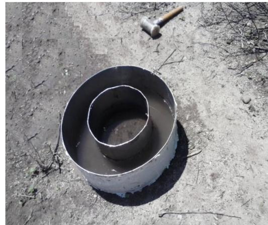
**Figura 11. Infiltración de agua en el suelo**
