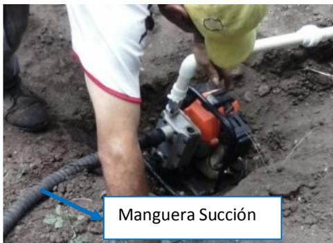
La bomba se acopla al sistema mediante 2 adaptadores macho y un adaptador universal, que facilite el traslado de la unidad hacia otro sitio de bombeo.
