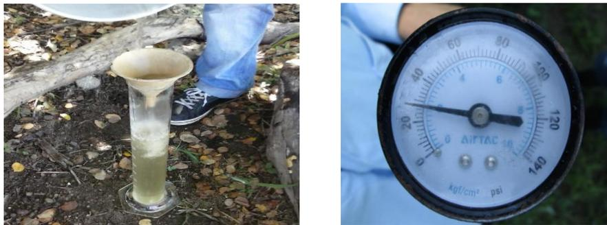
**Figura 22. Aforo de la unidad de riego y medición de la presión**
