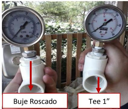
Los manómetros se ubican a la entrada y salida de la unidad de filtrado, con el objetivo de regular la presión de trabajo del sistema de riego y determinar la limpieza de los filtros en base a la caída de presión.
