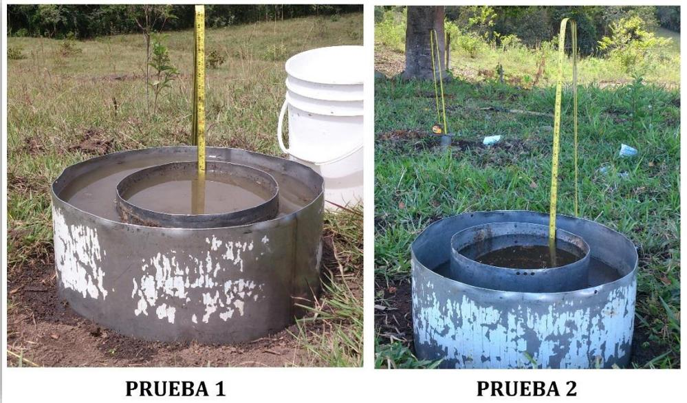
**Figura 24. Pruebas 1 y 2 método de anillos infiltrómetros.**
