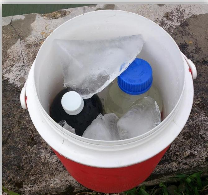
**Figura 29. Transporte de las muestras de agua.**
