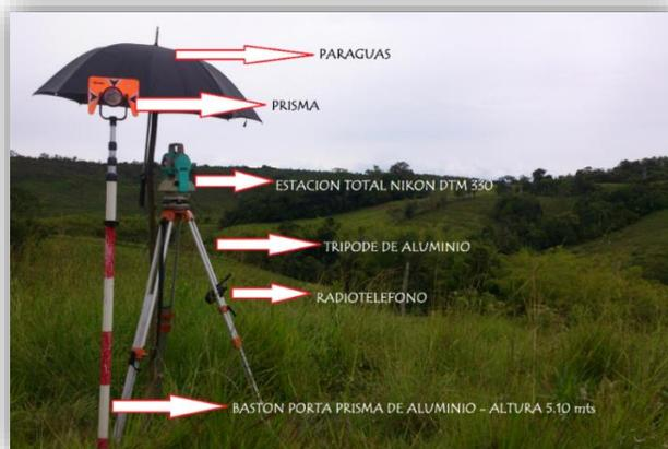
**Figura 6. Equipos utilizados para el levantamiento planialtimetrico.**
