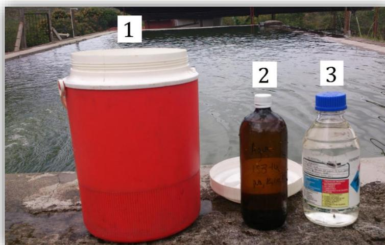
**Figura 27. Recipientes utilizados para la recolección y transporte de las muestras de agua.**
