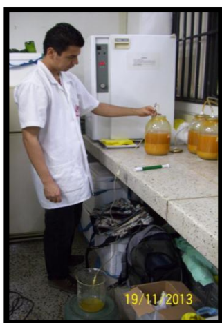
Figura 9. Separación del vino y el sedimento
