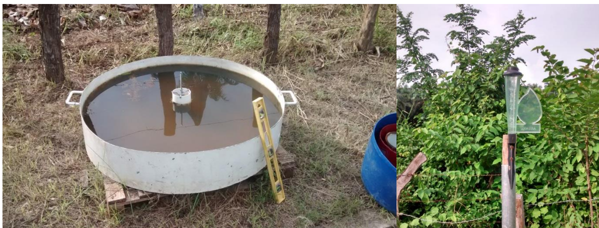
Imagen 3. Tanque evaporímetro tipo A y pluviómetro - Palmares de Zacapa S.A.S.
