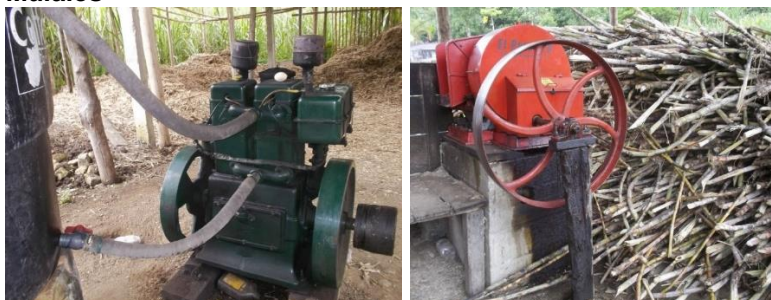
Figura 22. Der. Motor Diesel Tipo Lister. Izq. Trapiche Alta Extracción El Panelero, Finca Mulales
