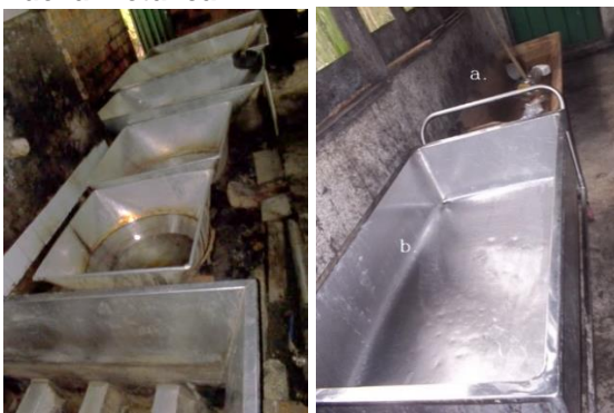
Figura 24. Izq. Hornilla Ecoeficiente Finca Santa Helena. Der. a. Pacha antigüa. b. Pacha nueva metálica.
