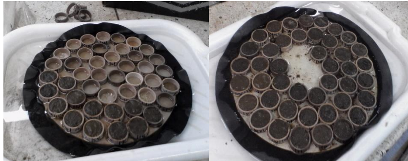
Figura 11. Muestras de suelo en saturación, plato poroso de 0.3 y 15 bar
