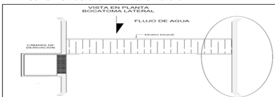
Figura 35. Vista en planta muro lateral
