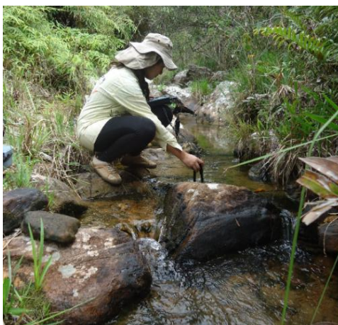
Figura 26. Muestreo manual de tipo puntual para la determinación de la calidad de agua con fines de riego en la quebrada el Coco.
