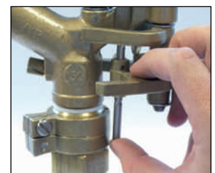
Sencillo desbloqueo del sector de riego
