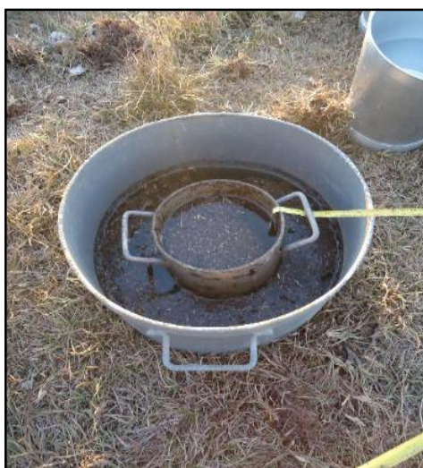
Figura 20. Prueba de infiltración en la finca Ojo Real, Municipio de Paicol.
