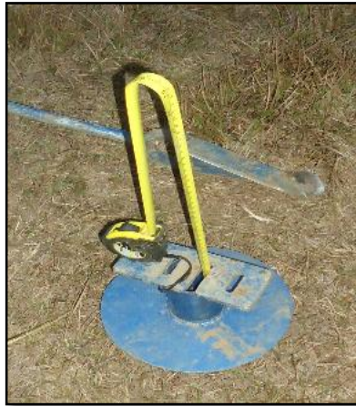
Figura 18. Prueba de conductividad hidráulica en la finca Ojo Real, Municipio de Paicol.
