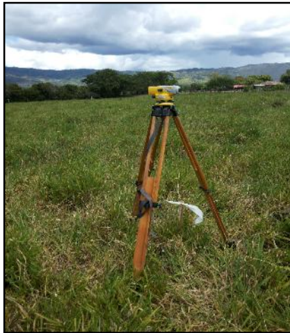
Figura 7. Nivel de precisión SOKKIA C22.
