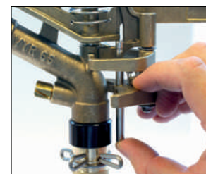
Sencillo desbloqueo del sector de riego
