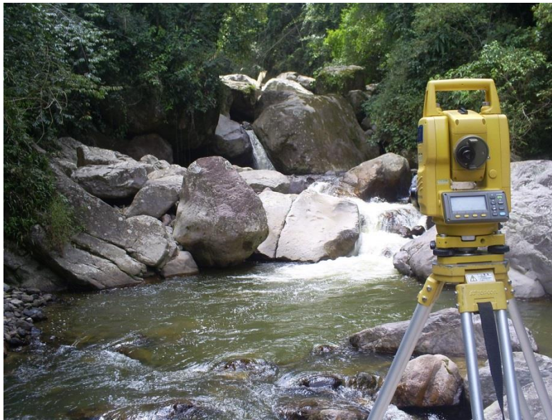
Figura 6. Estación Total TOPCON GTS 239W Fuente: Ingeniería de Riegos y Obras Civiles Ltda, 2012
