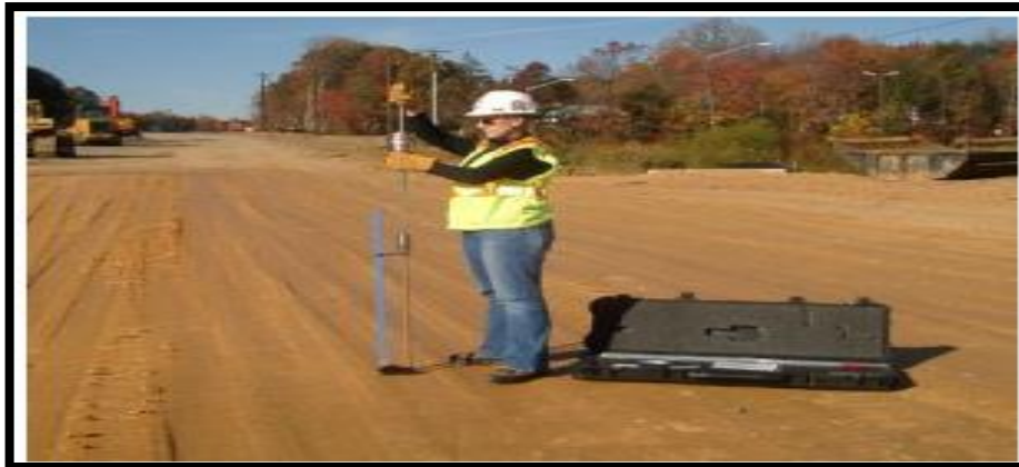
Figura 6. Ensayo con e PDC-Penetrometro Dinámico de Cono.
