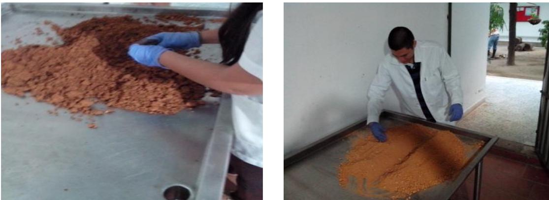
Figura 15: a) homogenización de los 10 prototipos por tratamiento, b) cuarteo y toma de muestra.
