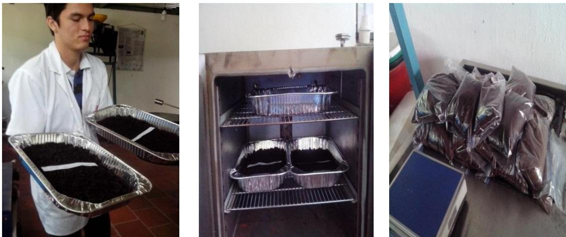
Figura 4. a) Bandejas con borra de café, b) secado en horno, c) almacenamiento de borra de café.
