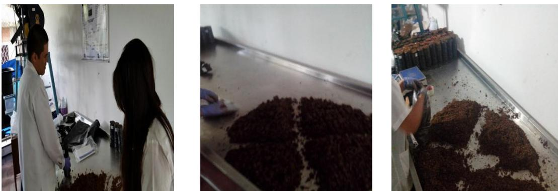
Figura 10: a) homogenización de los tratamientos, b) cuarteo de los tratamientos, c) toma de la muestra de los tratamientos.
