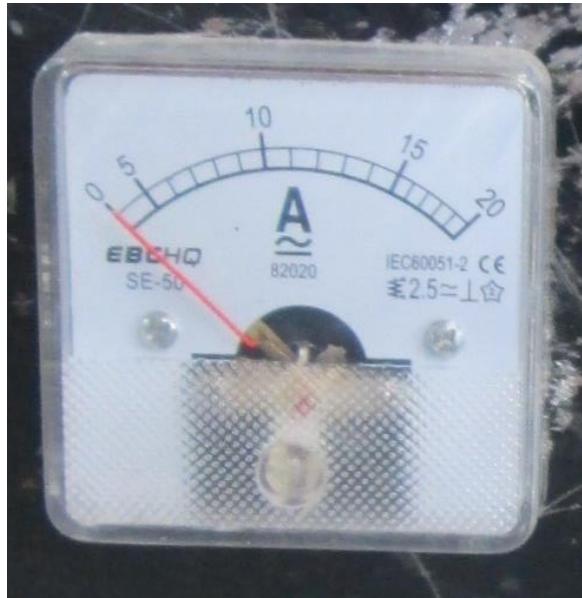
Figura No 10 - Instrumento para la medición de amperios (Amperímetro) en escala de 0 - 20 A.
