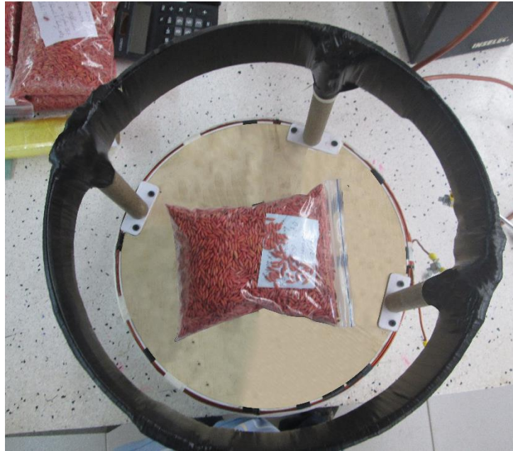
Figura No 8 - Bobina Helmholtz para la aplicación del campo electromagnético en semillas de arroz variedad Coprosem 304.
