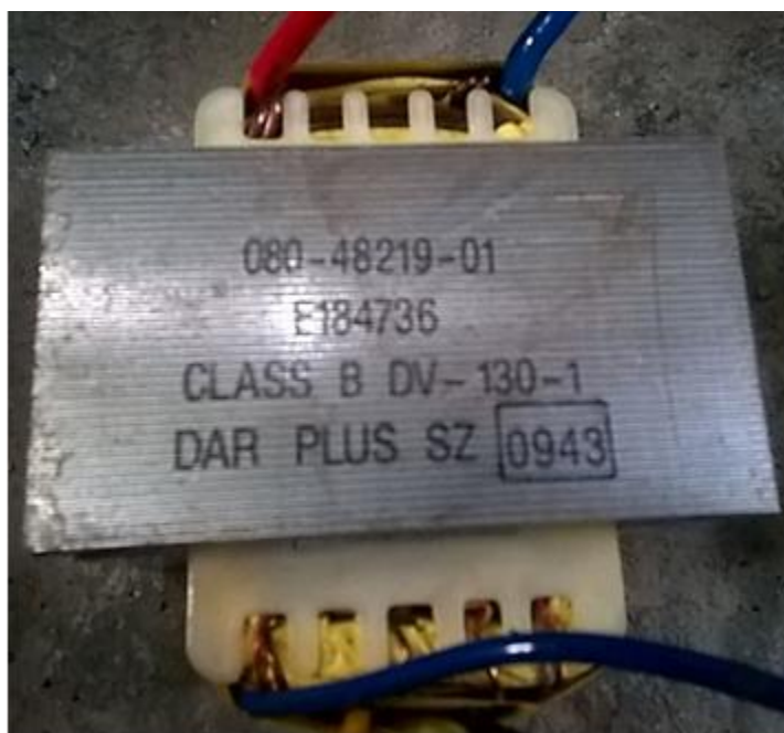
Figura No 9 - Tipo de transformador empleado en la fuente de alimentación (AC)
