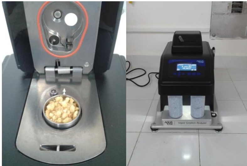
Figura 5. Determinación puntual actividad de agua.
