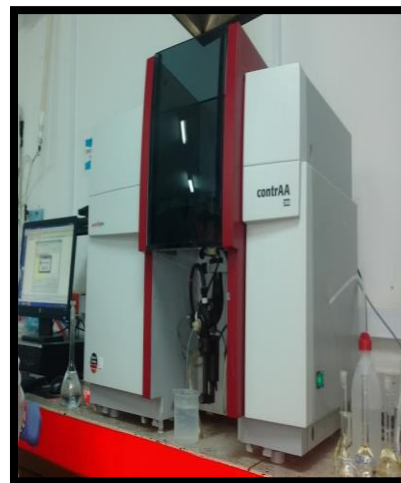
Figura 5. Trabajo de laboratorio: a) Extracción de menores b) Extracción de bases y determinación de CIC, c) determinación de metales con fotometría y absorción atómica
