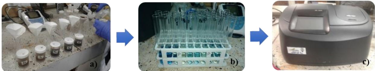
Figura 8. a) Montaje para la determinación de fósforo en el suelo b) desarrollo del color con \text{SnCl}_2 , c) espectrofotómetro.
