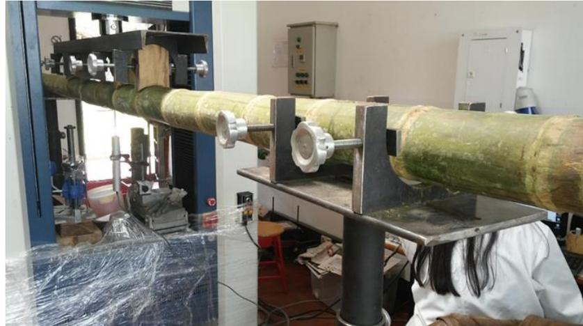
**Figura 10** Probeta de guadua apoyada en sus extremos y con aplicación de la carga en el tercio medio.
