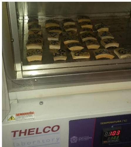
**Figura 12** Secado de las probetas de guadua, Laboratorio de maderas y guadua. Universidad Nacional Sede Bogotá.
