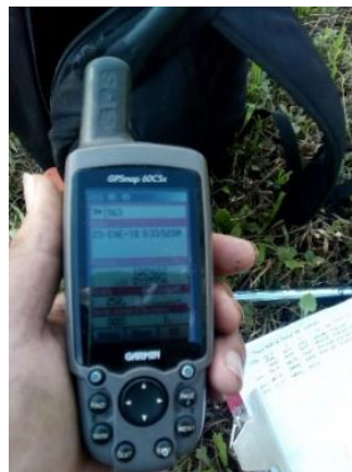
Figura 6. GPS para la identificación de obras
