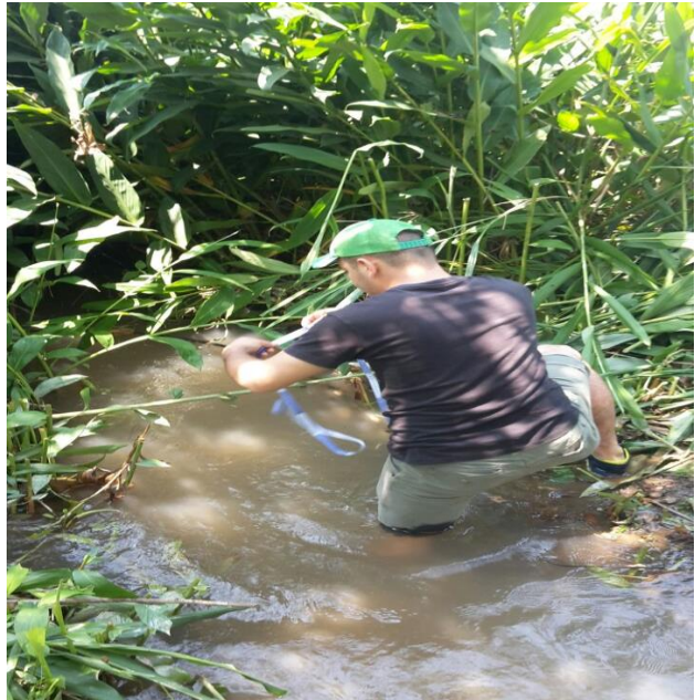
Ilustración 23: Aforo Manual Canales de Castalia Garzón Huila
