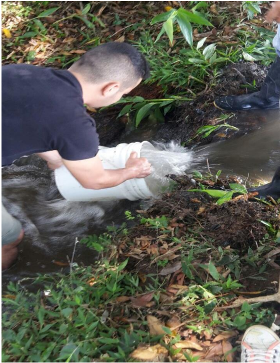
Ilustración 24: Aforo Volumétrico Canales de Castalia
