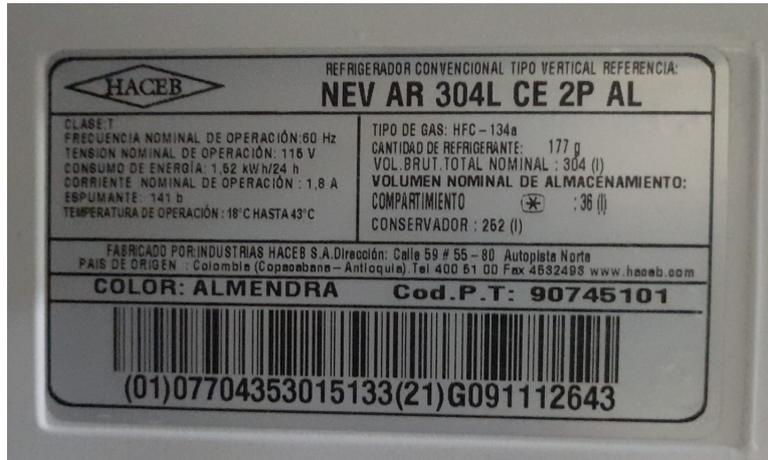
Figura 5.3: Parámetros energéticos eléctricos de un refrigerador convencional.
