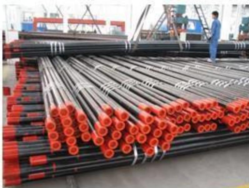
Figura. 19. Tubería de producción de 3 ½ pulgadas
