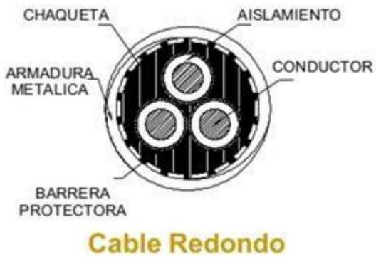
Figura. 16a Cable de potencia redonda y sus componentes.
