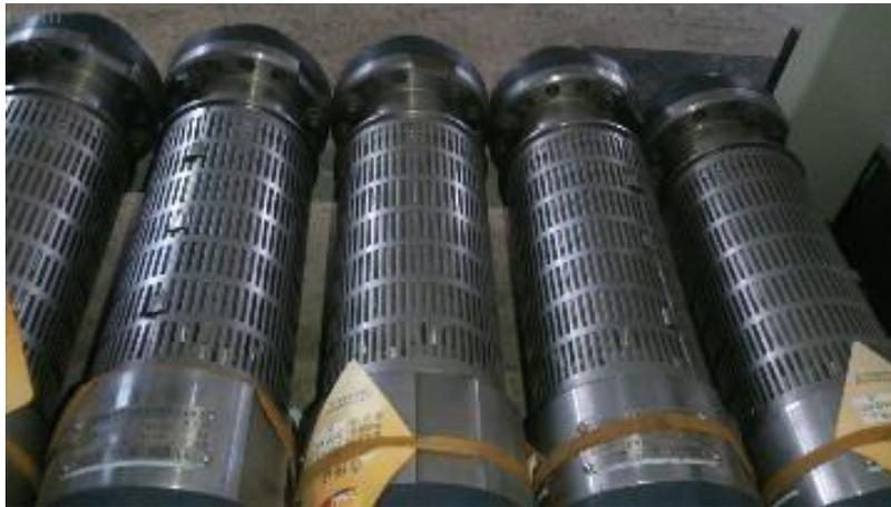
Figura 9. Intake o entrada de una bomba electrosumergible.
