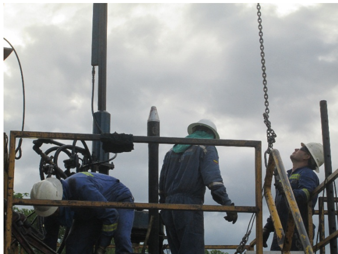
Figura 33. Bala de inserción instalada
