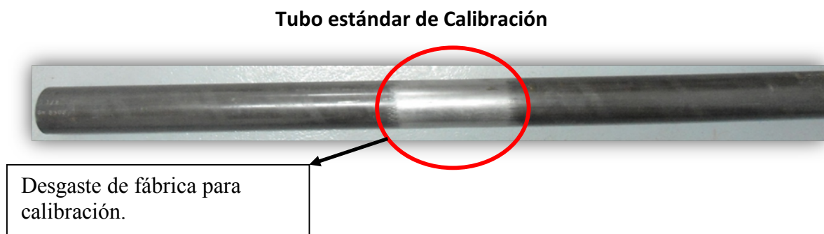
Figura 49. Desgaste de fábrica para calibración
