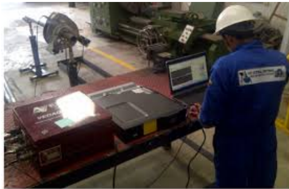
Figura 13. Inspección electromagnética (fuente: NDT integral solutions S.A.S.)
