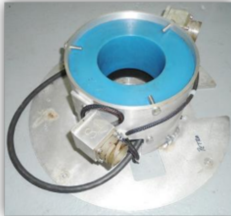
Figura 58. Cabezal porta sensores
