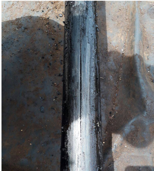
Figura 22. Tubo roto debido al roce de varilla (Bombeo Mecánico)
