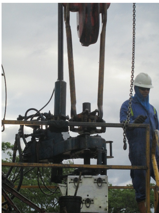
Figura 36. ARTIS 4 con llave hidráulica encima
