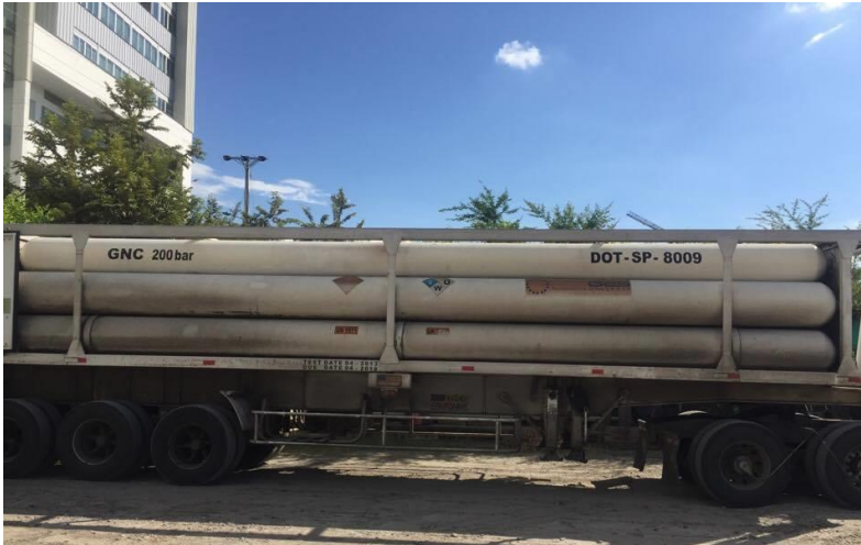
Ilustración 2. Sistema de almacenamiento GNC.
