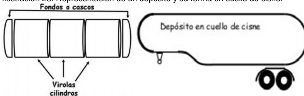
Ilustración 28. Representación de un depósito y su forma en cuello de cisne.
