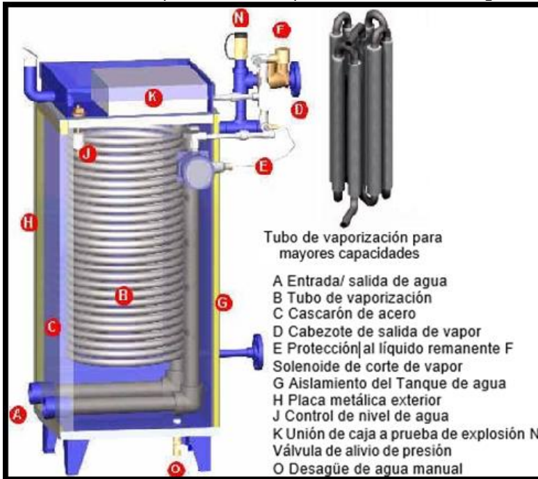
Ilustración 48. Componentes del vaporizador de baño de agua vertical.
