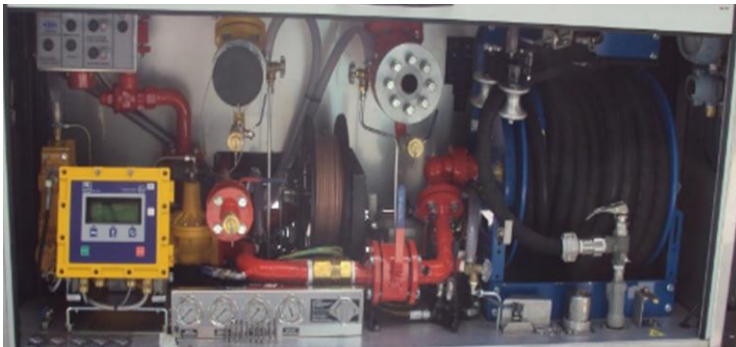
Ilustración 33. Armario de válvulas.
