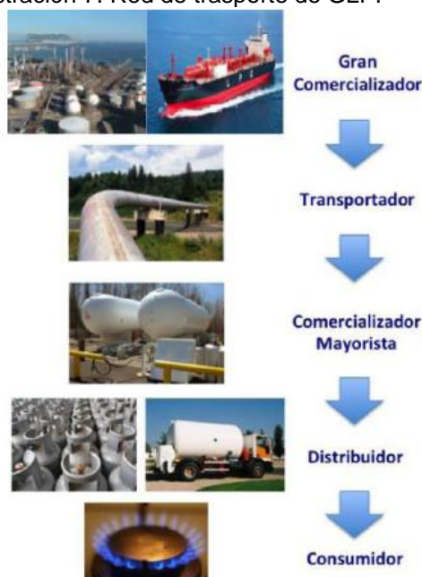
Ilustración 7. Red de transporte de GLP.
