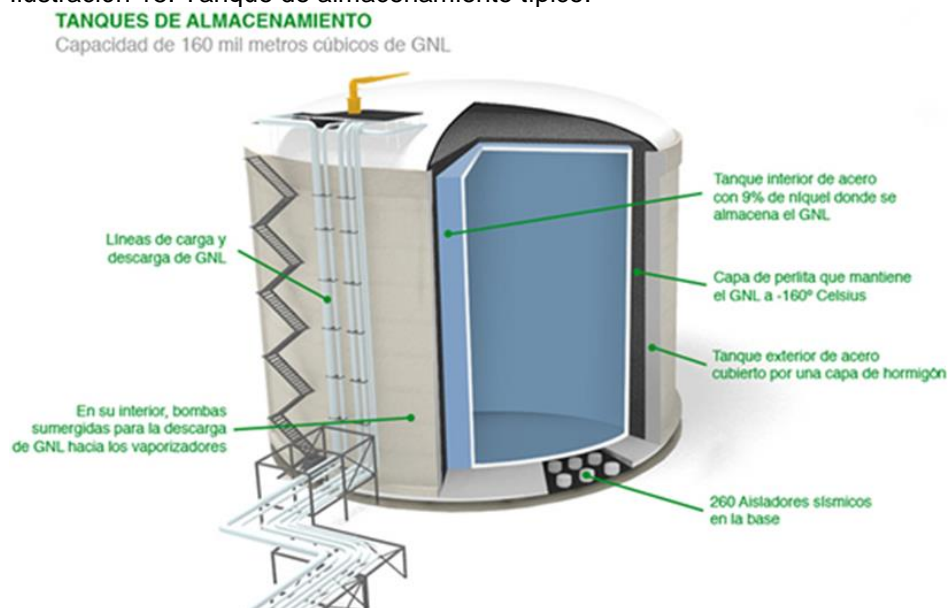
Ilustración 15. Tanque de almacenamiento típico.
