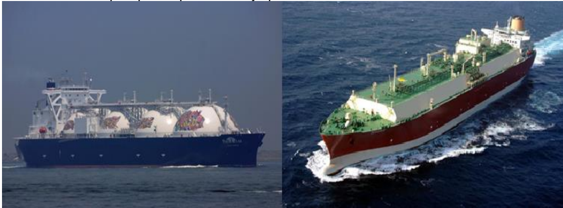
Ilustración 16. Buque tipo tanque esférico y tipo membrana.
