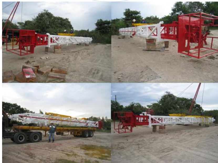
Figura 47. Re ensamblada de la torre luego del todo el trabajo de inspección. Fuente: S.I (Servicios de Inspección)
