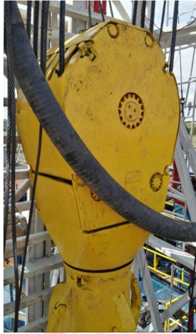
Figura 60. Bloque viajero enhebrada con 8 líneas.
