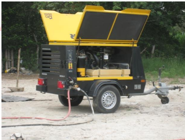
Figura 35. Compresores Ingerson Rand de 250 CFM presión de trabajo 100 PSI Fuente: S.I (Servicios de Inspección)
