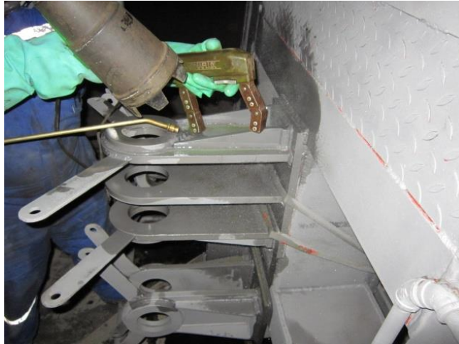
Figura 42. Yoke magnetizando donde se aplican las partículas magnéticas Fuente: S.I (Servicios de Inspección)
