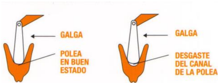
Figura 57. Inspección a las poleas por medio de galgas. Fuente: http://sector-metalurgico.com/index.php?content=96
