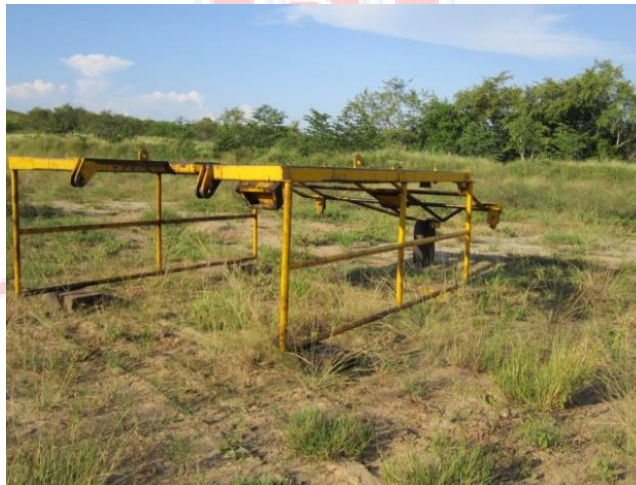
Figura 33. Trabajadero para tubería. Fuente: S.I (Servicios de Inspección)
