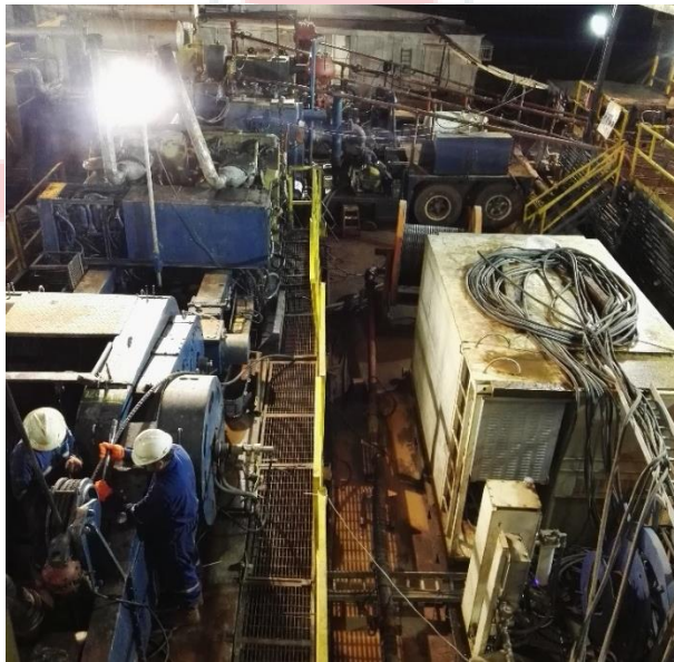
Figura 83. Conexiones de cables eléctricos e hidráulicos de la mesa de trabajo.
