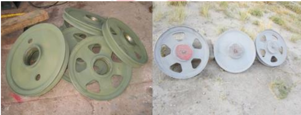
Figura 55. Poleas pulidas y poleas repintadas después de la inspección. Fuente: S.I (Servicios de Inspección)
