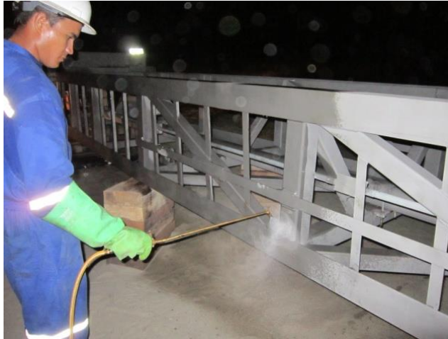
Figura 40. Limpieza y remoción de las partículas magnéticas Fuente: S.I (Servicios de Inspección)
