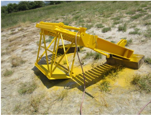
Figura 52. Trabajadero de pintura finalizado luego de las reparaciones realizadas. Fuente: S.I (Servicios de Inspección)
