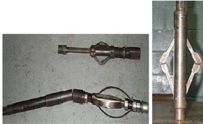
Figura 26. Herramienta Kick-over tool tipo L. (BERARDO GIRALDO, 2009)
