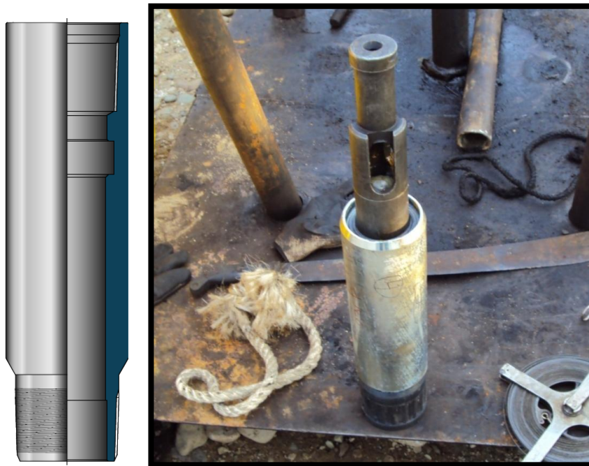
Figura 22. Nipple modelo F con standing Bold incrustada. (TEXPROIL, 2013)
