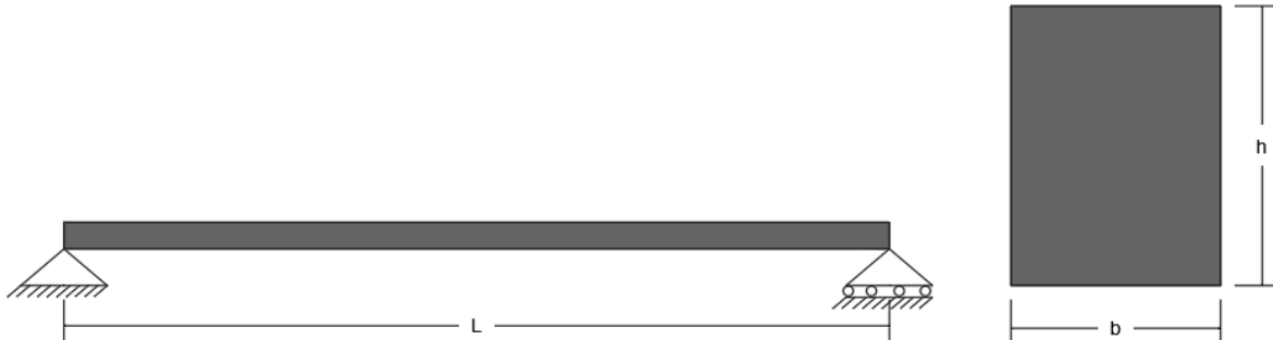
Figura No.1: Viga simplemente apoyada - Corte transversal.
