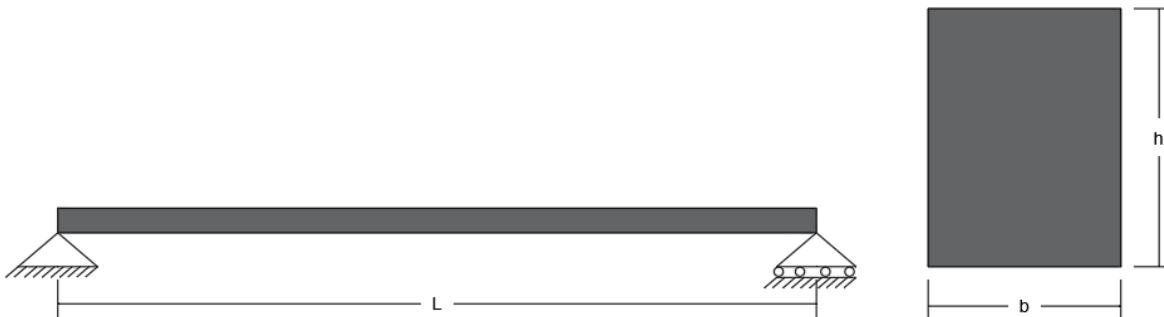
Figura No.2: Viga simplemente apoyada - Corte transversal.
