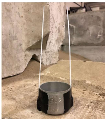
Figura 3-8 Lata de densidad empleada para determinar la densidad final de la arena limpia mal gradada. Tomada de Wallace (2019).
