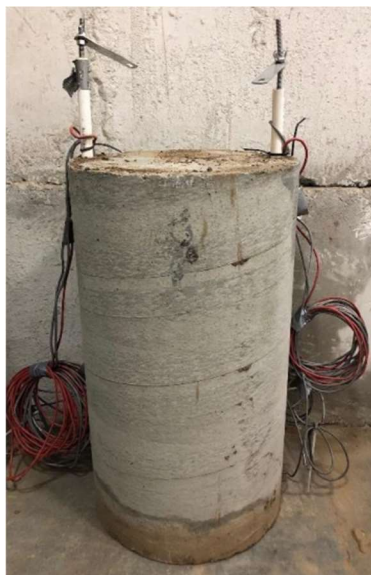
Figura 3-6 Modelo final del pilote utilizado durante la prueba de laboratorio. Tomada de Wallace (2019).
