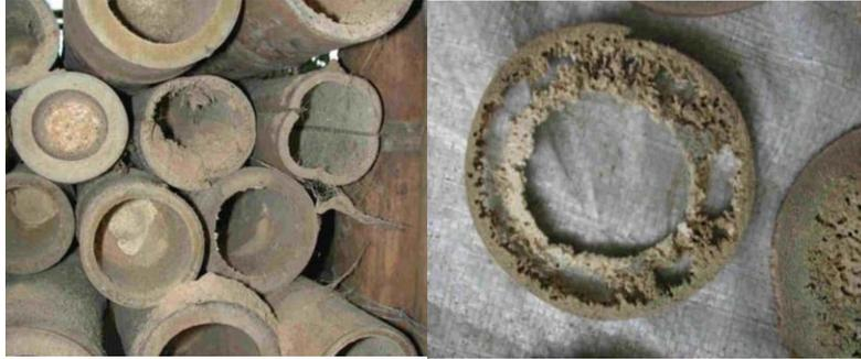
*Ilustración 5. Daño por xilófagos Fuente: (Figura 1. Ataque Biótico, Destrucción Total de La Guadua, Por Insectos..., 2022)*
