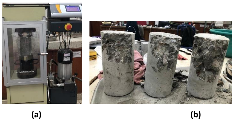
Figura 3-13: (a) Prensa hidráulica (b) Especímenes cilíndricos fallados.
