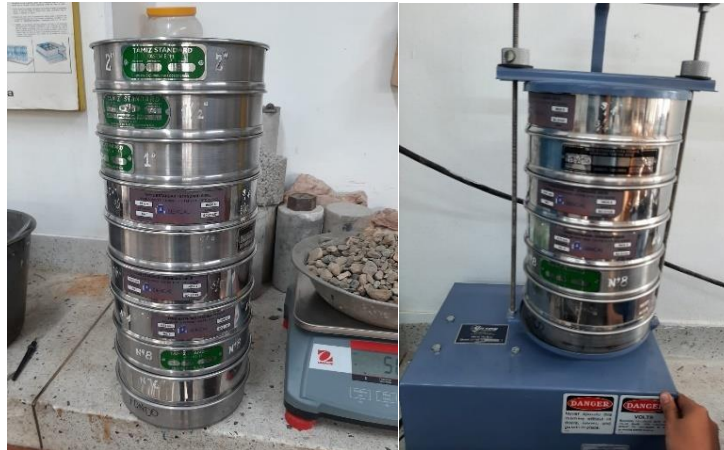
Figura 1-7: Tamizado de los agregados.
