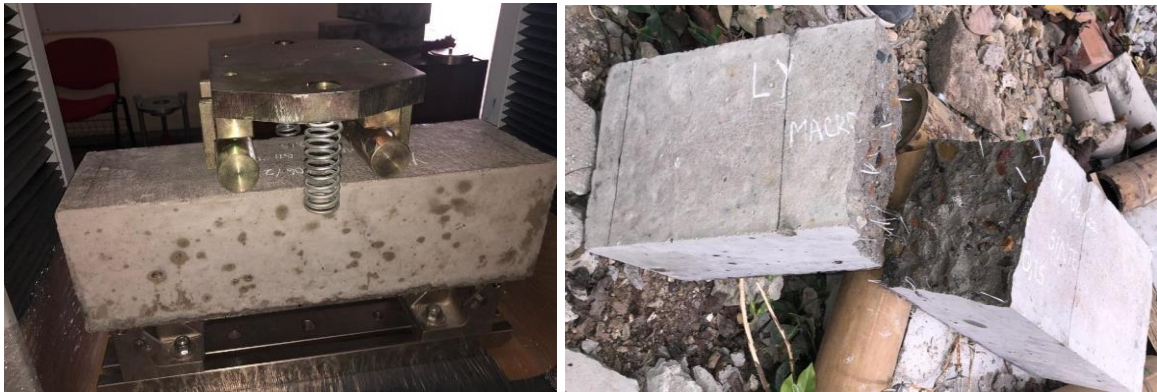
Figura 3-14: Ensayo a la flexión de vigas en los tercios medios y muestra prismática fallada.
