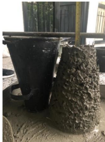
Figura 3-10: Medición del asentamiento fibra sintética.
