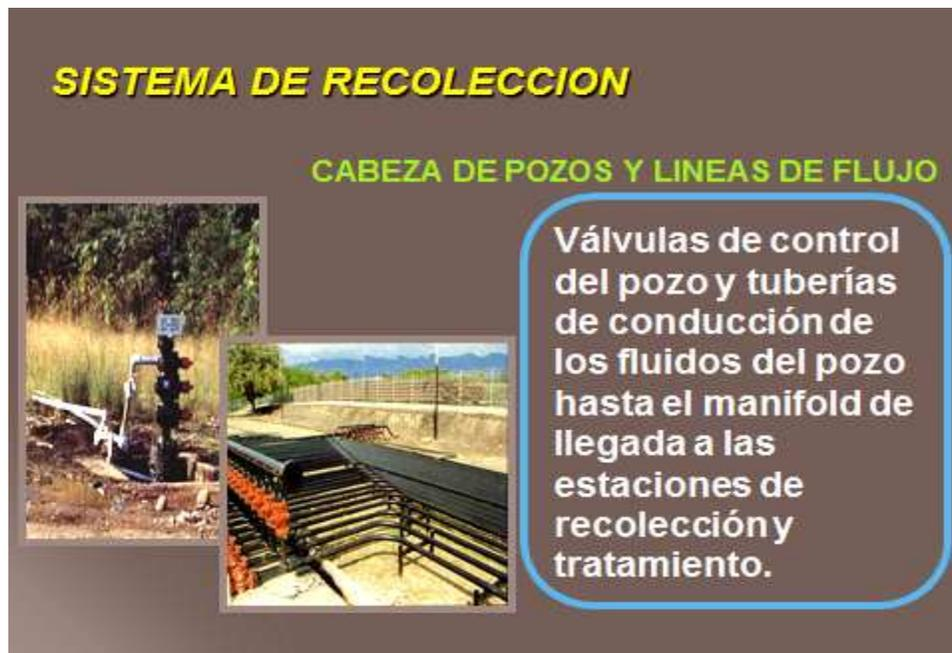
Fig. 8 Cabeza de pozo y líneas de flujo que conducen el crudo hacia los centros de recolección, tratamiento y despacho
