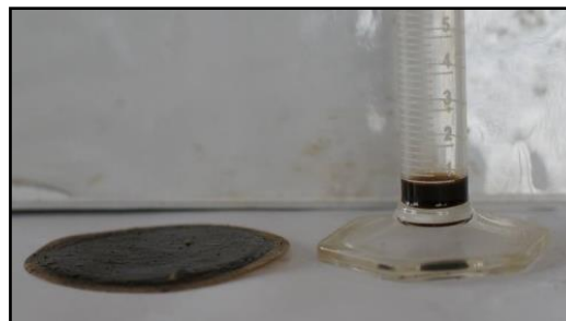
Figura 35. Filtrado OBM 1,9 mL 10 ppg 65 lb/bbl de CaCO 3 malla 150/400 post envejecimiento a 300°F y 100 psi
