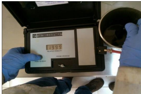
Figura 43. Test de estabilidad eléctrica. Al lodo base aceite de higuierilla.
