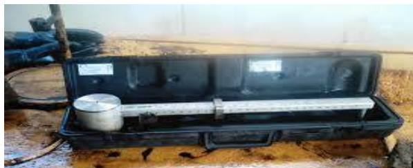
Figura 2. Balanza de lodo – medición de densidad Fuente: Autora
