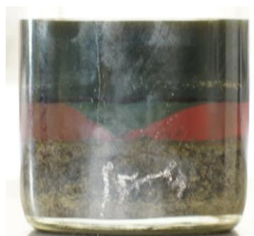
Figura 2. Prueba de compatibilidad OBM de Higuierilla y Fluido de confinamiento.
