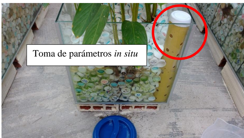
Figura 19. Adaptación para toma de parámetros in situ
