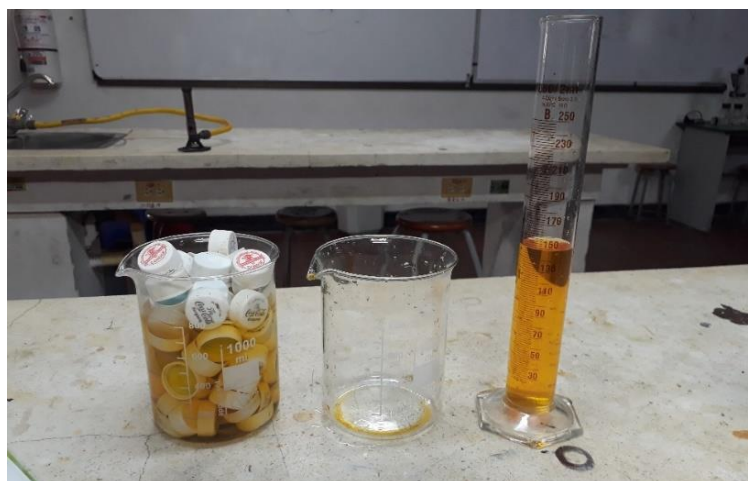
Figura 24. Determinación de porosidad del material granular
