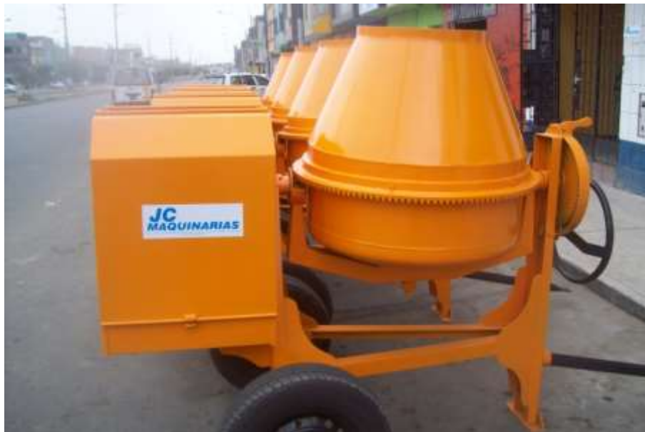
Figura 33 Mezcladoras manuales de concreto.
