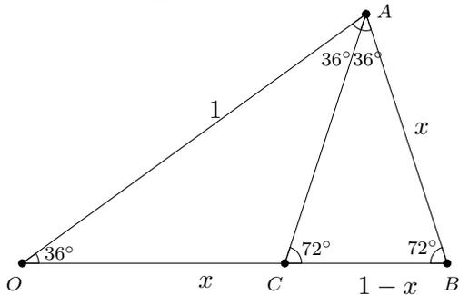
Si suponemos que la circunferencia circunscrita tiene radio 1 y si llamamos  $x$  al lado del decágono entonces:  $\overline{AC} = \overline{OC} = x$ ;  $\overline{CB} = 1 - x$ ; por la semejanza de los triángulos  $OAB$  y  $ABC$  podemos establecer las siguientes proporciones: (ver figura 1.12.2)
