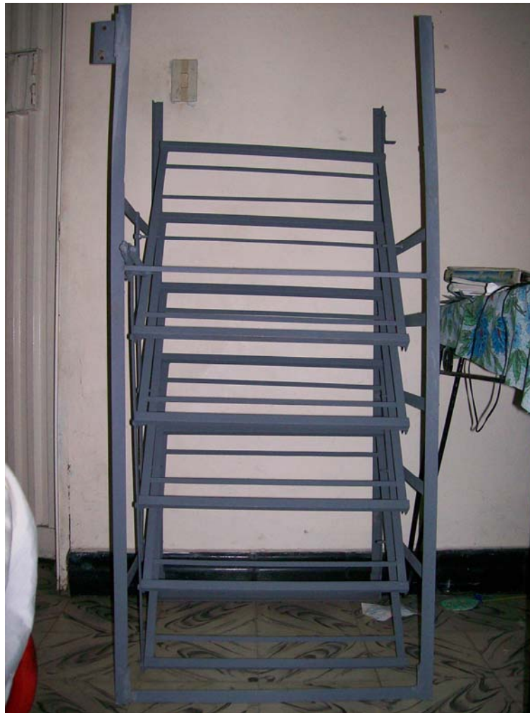
Fig. 19 Sistema del giro de los huevos
