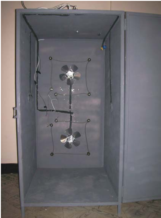
Fig. 12 Sistema de regulación de temperatura
