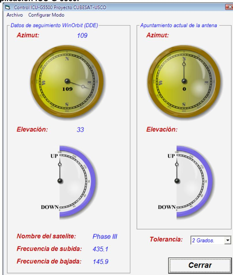
En la parte izquierda, el programa nos muestra el valor del azimut (por medio de la brújula) y la elevación actual de la antena. Además nos permite cambiar el valor de la tolerancia para el seguimiento de la antena entre  $\pm 1$ , 2, 3, 4, 5 y 10 grados. Esto nos permite hacer más o menos preciso el movimiento de las antenas, dependiendo de las necesidades del proyecto.
