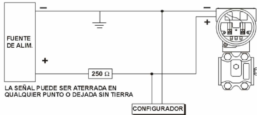
Figura 7. Diagrama de conexión del smar LD 301 como Transmisor.
