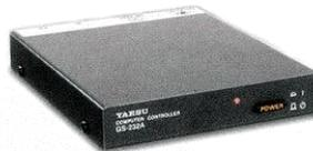
Este dispositivo posee un terminal macho RS-232 que se conecta con el PC mediante un cable DB-9 en el puerto COM RS-232 o serie de la computadora. También contiene un terminal eléctrico donde se le deben suministrar 12 VDC a 110 mA con los que trabaja. Igualmente posee un cable para la conexión con el controlador G-5500 consistente en un conector dual 5-pin y en su otra terminal un conector DIN<sup>17</sup>, la conexión y los cables pueden apreciarse en la figura 15.
