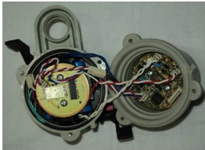
Figura 10. Partes del Indicadores de Falla TST-OL
