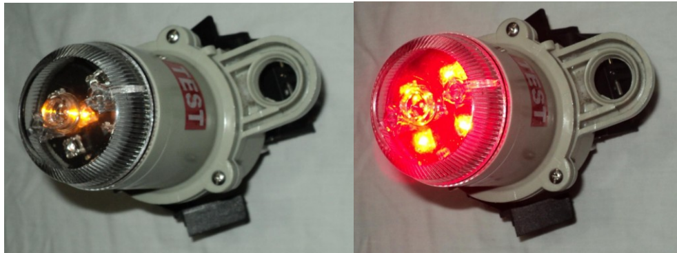
Figura 17. Indicación de Falla Transitoria y Permanente
