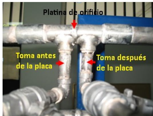
Figura 19. Ubicación de la platina orificio y las tomas para la medición de la presión diferencial en el banco.
