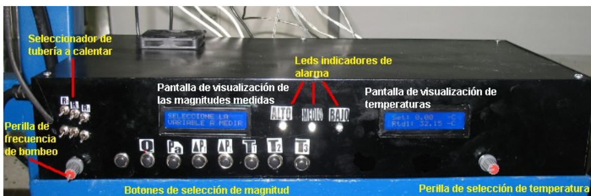
Figura 20. Fotografía descriptiva del Centro inalámbrico de control electrónico.
