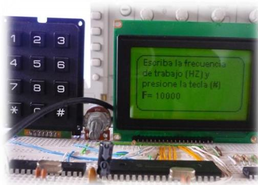
Figura 8: prueba de oscilador 0 – 5V
