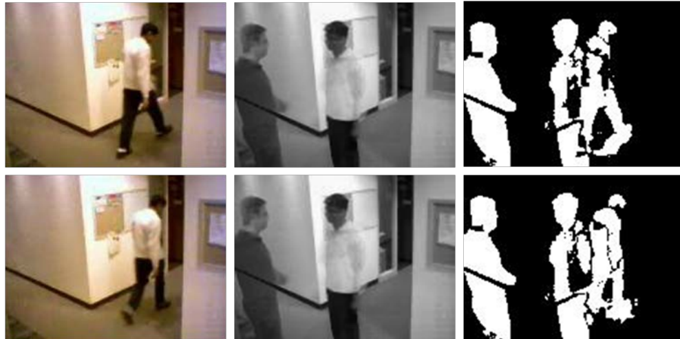
Figura 26. Actualización inadecuada del modelo de fondo ( Frame 249, 253 )
