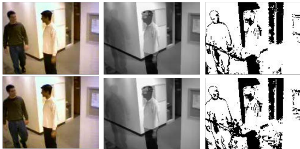
Figura 25. Estimación errónea del modelo de fondo debido a cambios bruscos de luz ( Frame 118, 120 )
