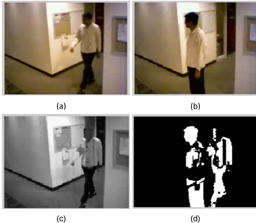
Figura 6. (a) Inicialización de fondo con objetos en movimiento, (b) Frame actual, (c) Adaptación de fondo con inicialización incorrecta y (d) Detección incorrecta de objetos en movimiento.
