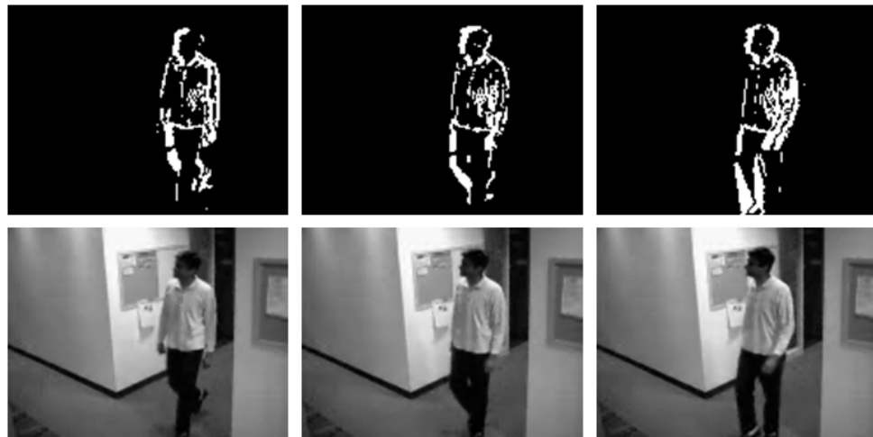
Figura 18. Detección de objetos en movimiento utilizando la diferencia de frame adyacente ( Frame 36, 38,40 )
