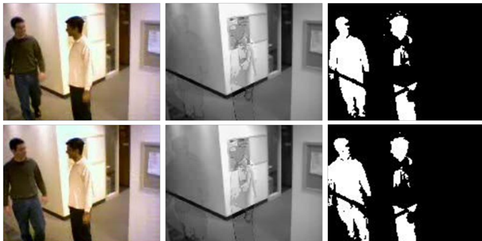
Figura 29. Corrección de los efectos generados por cambios bruscos de luz ( Frame 118, 122)
