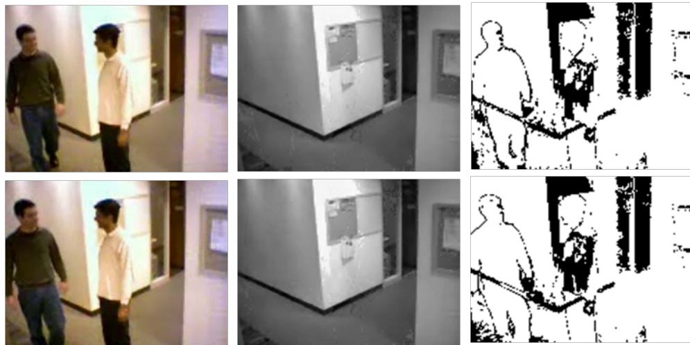
Figura 28. Inconvenientes de adaptación del modelo de fondo debido a cambios bruscos de iluminación ( Frame 118, 122 ).
