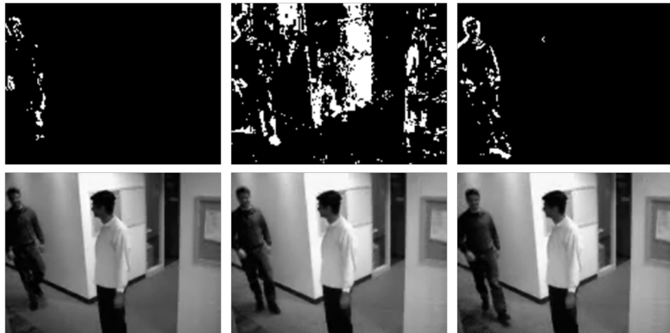
Figura 20. Detección inadecuada debido a cambios bruscos de luz y camuflaje ( Frame 103, 105, 107)
