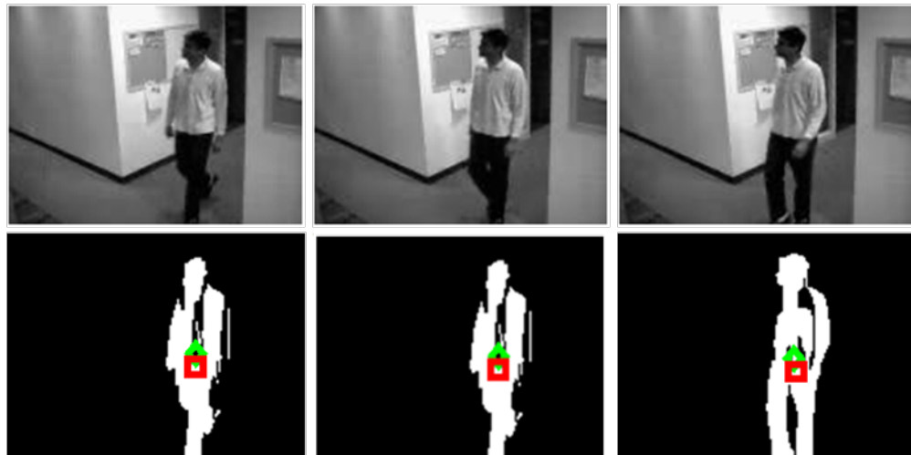
Figura 30. Seguimiento de un peatón utilizando el filtro de Kalman ( Frame 34, 36, 38 )
