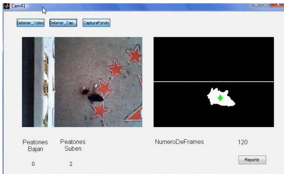
Figura 34. Ejecución del sistema de conteo con traslape de transeúntes
